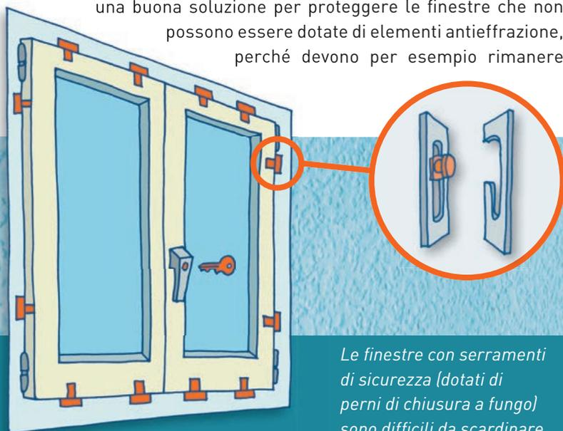
*Le finestre con serramenti di sicurezza (dotati di perni di chiusura a fungo) sono difficili da scardinare.*
