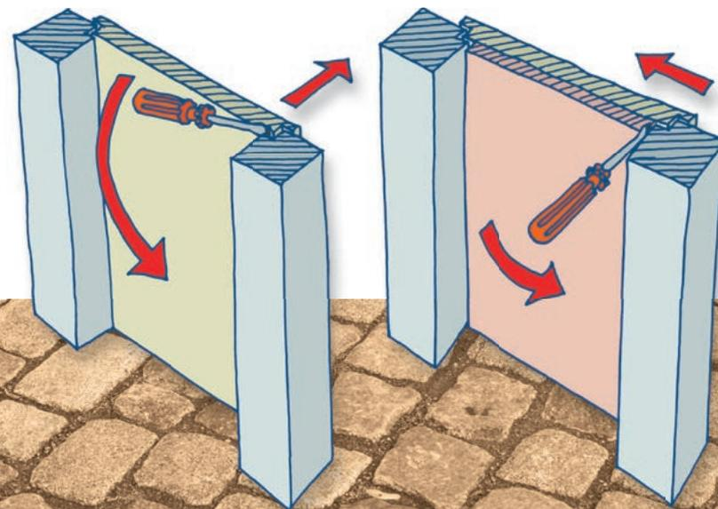
*Se il lato esterno di una porta è rafforzato con un pannello di legno supplementare, non è più possibile fare leva fra la porta e il lato interno del telaio (illustrazione a sinistra), perché si riesce solo a infilare una leva fra il telaio e il pannello di legno, ciò che è del tutto inutile ed inefficace (vedere illustrazione a destra).*
